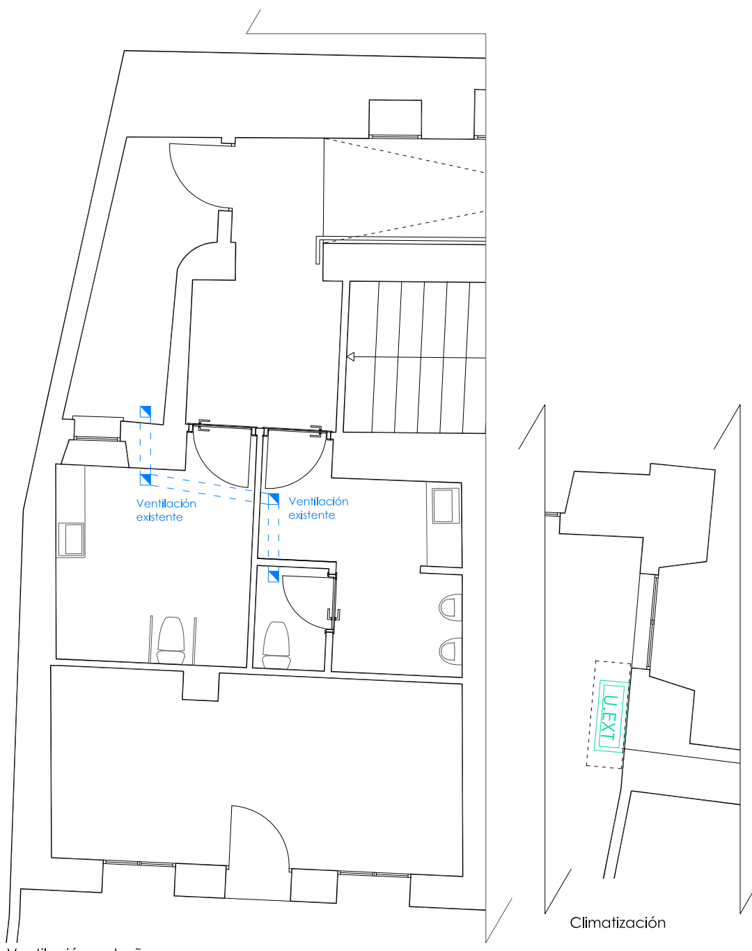
Ventilación en baños
