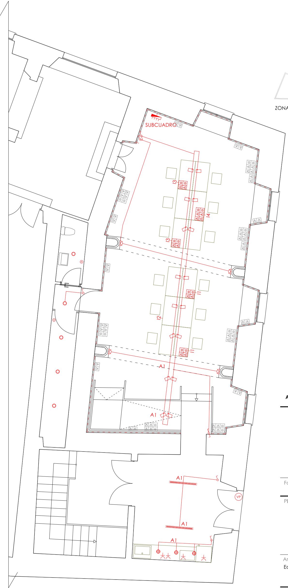
Iluminación y electricidad en sala de co-working, aseo y office
