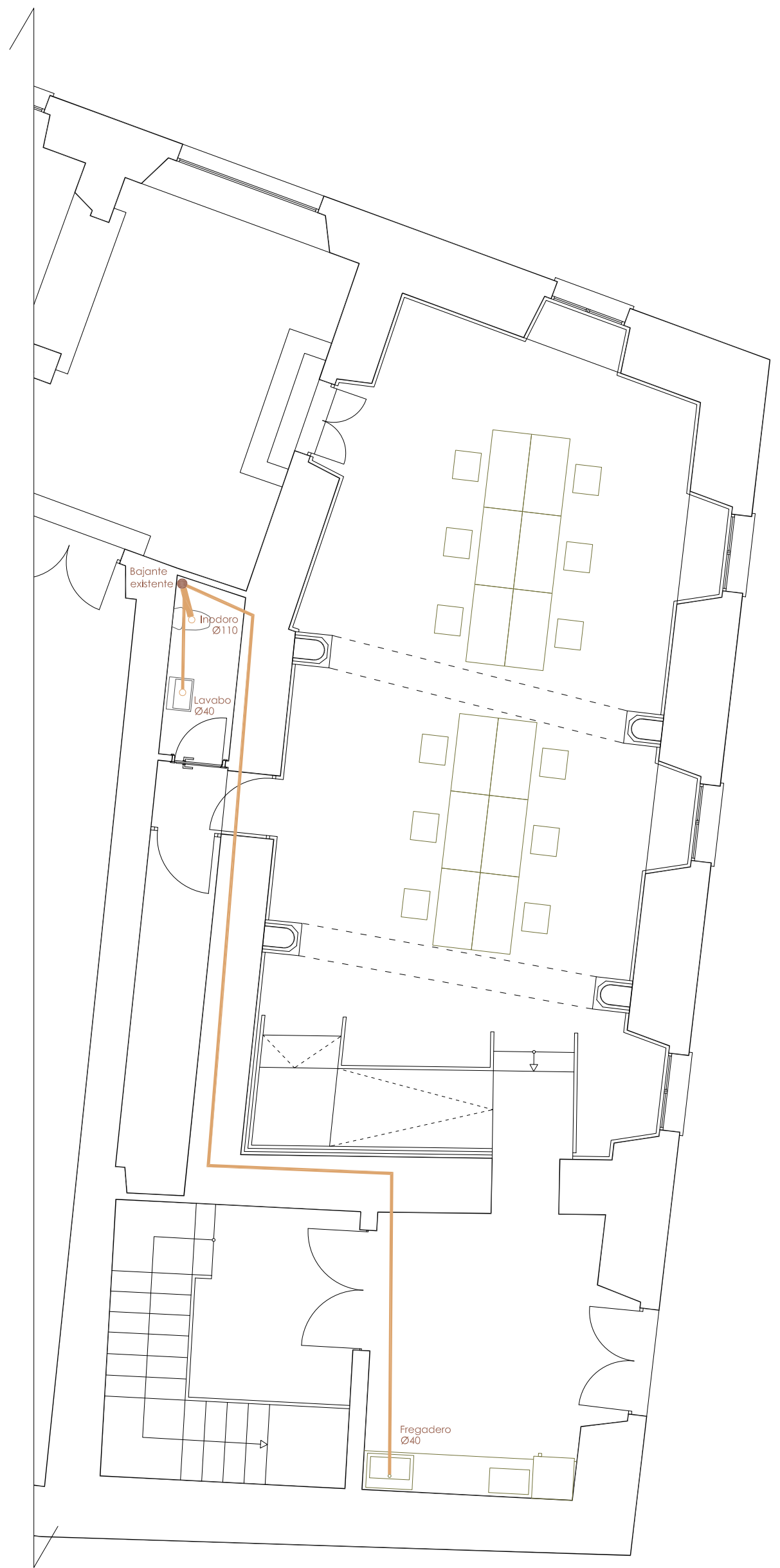
Saneamiento en aseo y office
